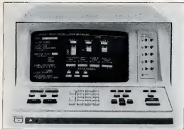
Analyseur Hewlett-Packard, modèle 1610 B. Il permet de contrôler l'ensemble des signaux et les données des programmes des assemblés à concevoir.
